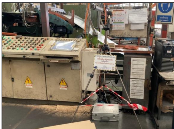
รูปที่ 3.11 การตรวจวัดระดับเสียงในพื้นที่ทำงาน ( L_{eq} 8 hr.) บริเวณ X-Y Blanking Machine
