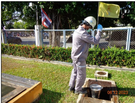
รูปที่ 3.4 การเก็บตัวอย่างคุณภาพน้ำทิ้ง
